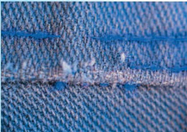
Zerscheuerte Nähte an exponierten Nahtpositionen wie z.B. an Ziernähten der Gesäßtasche oder an der Greiferfadenkette der Hosenbundansatznaht
