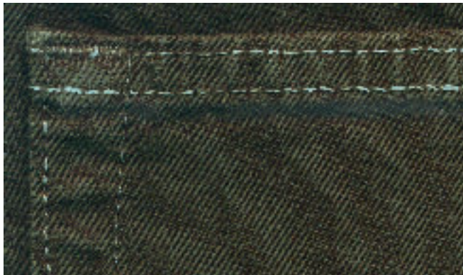
Melierte Nahtoptik aufgrund der Polyesterseele bei Einsatz von Baumwoll-Umspinnzwirnen
